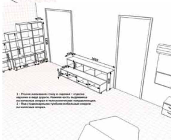
1 - Уголок мальчиков: стеллаж и сиденье - отделим картами и киди друзей. Нижняя часть поднимается на колесных опорах и телескопически выдвигается.
