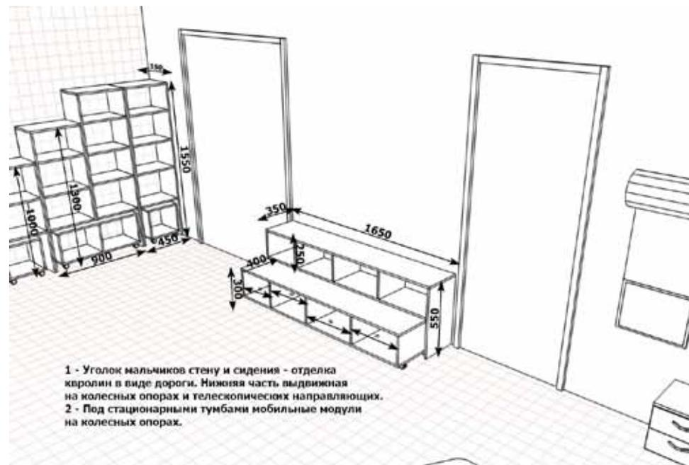
1 - Уголок мальчиков стены и сидения - отделка керолин в виде дорожки. Нижняя часть выдвигаемая на колесных опорах и телескопических направляющих.
